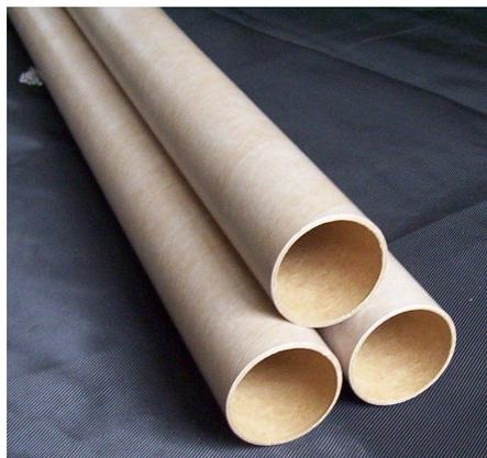
O Fenolite é um Plástico Termorrígido. Laminado formado basicamente por camadas de papel de origem especial (papel fenólico, tipo Kraft) e aglutinado em uma massa única com o uso de resina fenólica de altas características mecânicas para uso em baixa, alta tensão e alta frequência (de acordo com o tipo de fenolite). É um material rígido isolante, usado para isolamento elétrico, na substituição do baquelite e diversos outros isolantes elétricos.
